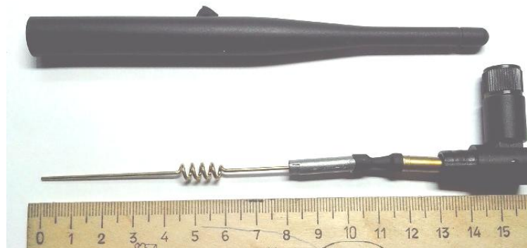
Рис. 11. Колінеарна антена роутера Wi-Fi
