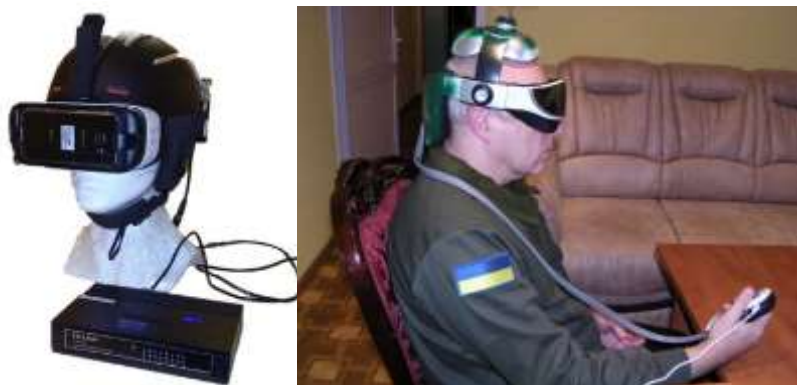
Рис. 7. Загальний вигляд шолома та блоку керування на демонстраційному стенді (зліва), випробування прототипу шолома (справа)
