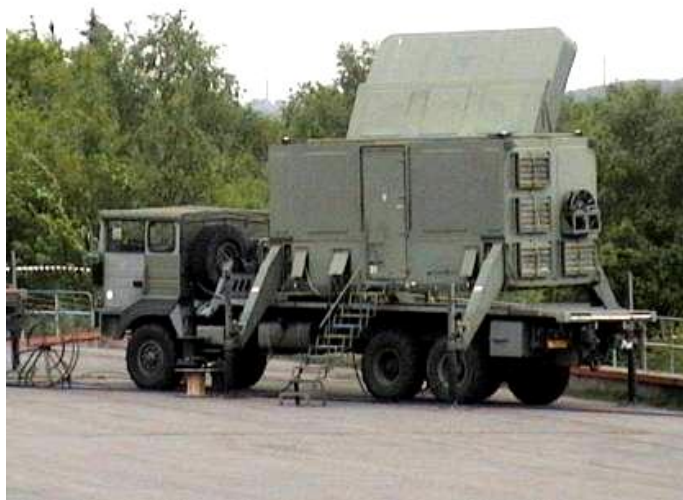
Рисунок 7 – Станция тропосферной связи (Франция).
