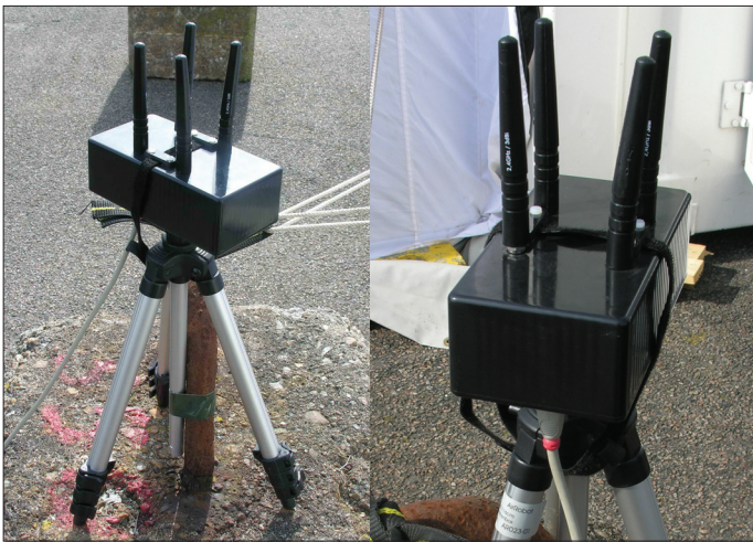
Рис.6. MIMO-система связи с БПЛА (приемник видеоданных AR023-01) компании AirRobot. Фото автора
