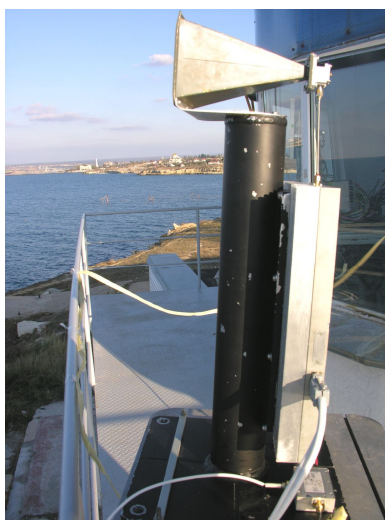
Рис. 2. Передавальний сегмент РЛС
