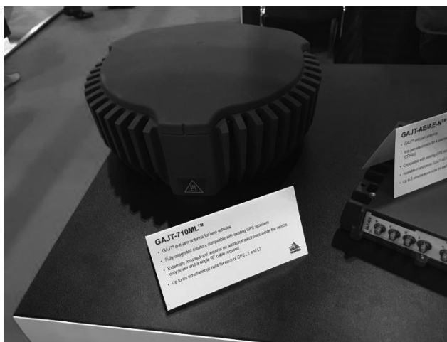
Рис. 6. 7-элементная ЦАР GAJT-710ML компании NOVATEL для подавления помех спутниковой навигации (Anti-Jam Antenna)
