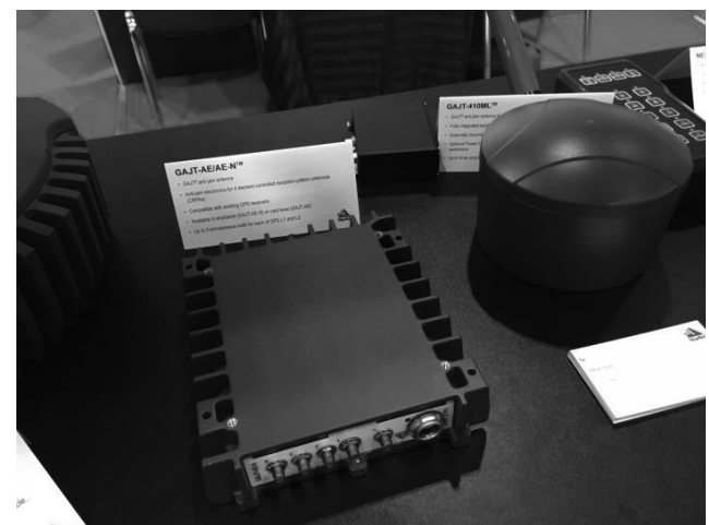
Рис. 7. 4-элементная антенная решетка GAJT-410ML в комплекте с модулем антенной электроники GAJT-AE-N
