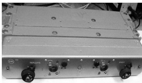
Рис. 3. Загальний вигляд блока частотних розв'язок РРС Р-409 діапазону "Б"
