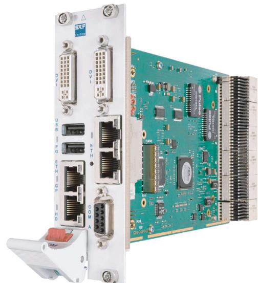
**Рис. 16. Процессорная плата с мезонинным контроллером PCJ-JAM**
