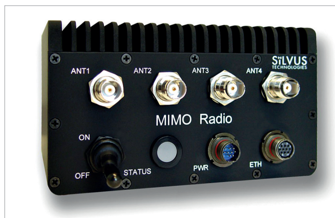
Рис.4. MIMO-репитер SC3500 фирмы Silvus Technologies
