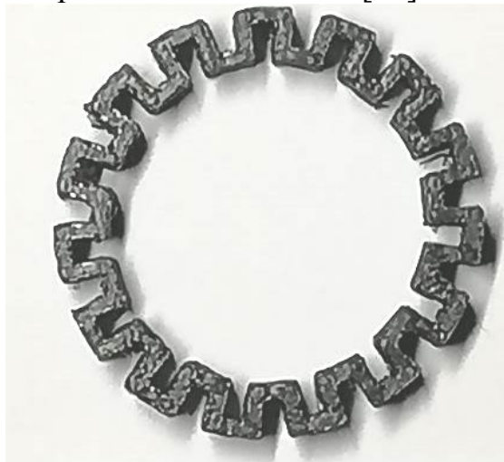
Рисунок 11. 3D-печать шаблона квазифрактального кольцевого вибратора
