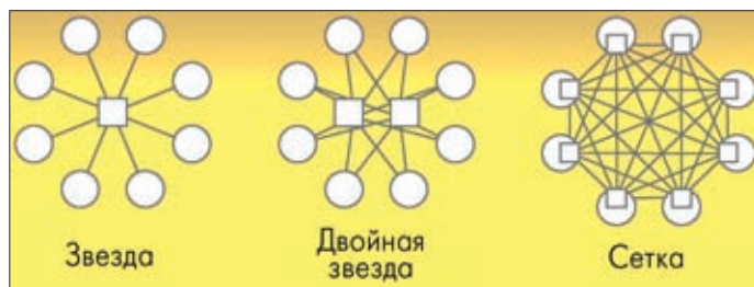
Рис.9. Варианты топологии разводки каналов PCI Express в ATCA, CompactTCA и MicroTCA
